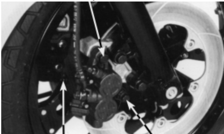
PARAFUSO DA PLACA DE FIXAÇÃO DOS PINOS DAS PASTILHAS
